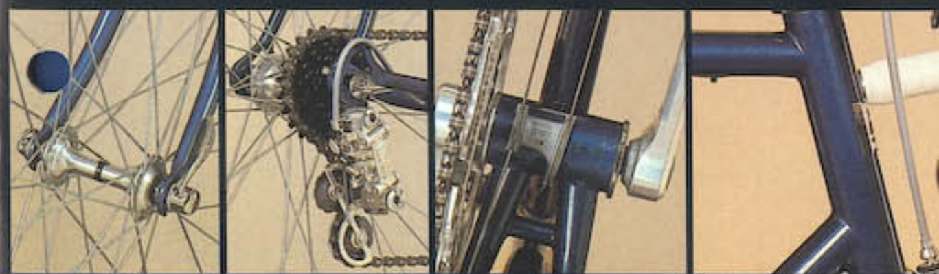
1 - CAMPAGNOLO RECORD HUB. - 2 - CAMPAGNOLO RECORD DERAILLEUR. - 3 - DERAILLEUR CABLE GUIDES. - 4 - COLOMBUS SL LUGLESS BRAZING.
